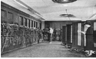
ENIAC (Electronical Numerical Integral and Calculator). 1945. Proyecto de la Universidad de Pensylvania, utilizaba 18000 bulbos.
